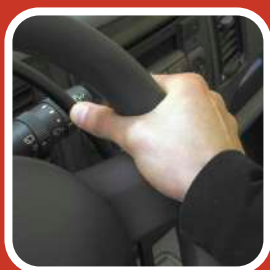
C. Presionar el aro con el pulgar desde el interior del volante
